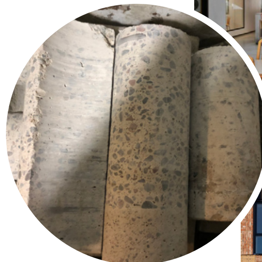
Exempel på materialspill som uppkommer under bygge: cylindrar från borrhål i tex betong
